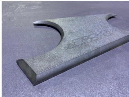
Schweißnahtvorbereitung bereits in einem Arbeitsgang mit dem Zuschnitt
