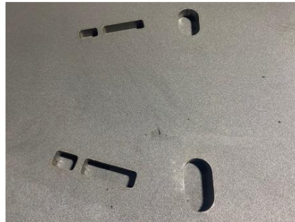
Einsparung von Fräsbearbeitung durch hochgenaue Schnittkanten
